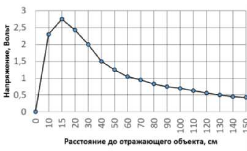
Рисунок 2 – График зависимости аналогового сигнала от расстояния до отражающей поверхности для датчика Sharp GP2Y0A02Y
